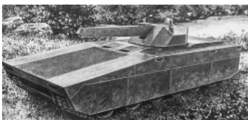
Рис. 1. Макет перспективного основного боевого танка (массой 55 т) – FCS (США) с электромагнитной пушкой
